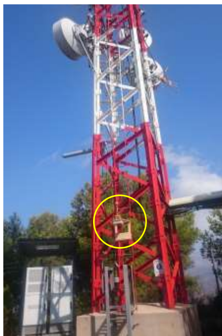
Útil de madera diseñado para facilitar la toma de muestras.
